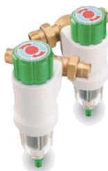
Sistema autopulente a doppia azione. Tramite la rotazione della manopola si si inverte la direzione del flusso per il controlavaggio ad alta velocità. L'acqua entra nel turbogetto e viene distribuita uniformemente sulla superficie e contemporaneamente avviene la spazzolatura della cartuccia. La cartuccia in rete di acciaio inox mantiene nel tempo il grado di filtrazione ed evita formazioni di vie preferenziali.
