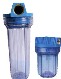
Filtri in plastica 2 pezzi: testata di colore blu, in PP caricato, con attacchi femmina con inserti in ottone, vaso SAN trasparente, ghiera di fissaggio per facilitare le operazioni di manutenzione e valvola di sfiato. Predisposti per fissaggio a parete. Adatti per trattamento di piccole e medie portate. Uso tecnico, residenziale, domestico. Progettato per cartucce standard da 5", 7" e 9"3/4 non incluse
