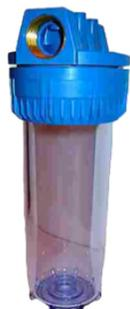
Filtri in plastica 3 pezzi: testata di colore blu, in PP caricato, con attacchi femmina con inserti in ottone, vaso SAN trasparente, ghiera di fissaggio per facilitare le operazioni di manutenzione e valvola di sfiato. Predisposti per fissaggio a parete. Adatti per trattamento di piccole e medie portate. Uso tecnico, residenziale, domestico. Progettato per cartucce standard da 5", 7", 9"3/4 e 20" non incluse
