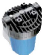
Contenitore in due pezzi per cartucce medie dimensioni con testa di colore nero, in PP caricato, con attacco femmina, senza inserti in ottone, con valvola di sfiato, vaso trasparente SAN azzurrato o opaco blu. Predisposto per il fissaggio a parete. Ideale per trattare importanti portate d'acqua. Progettato per cartucce con diametro 4,5" non incluse
